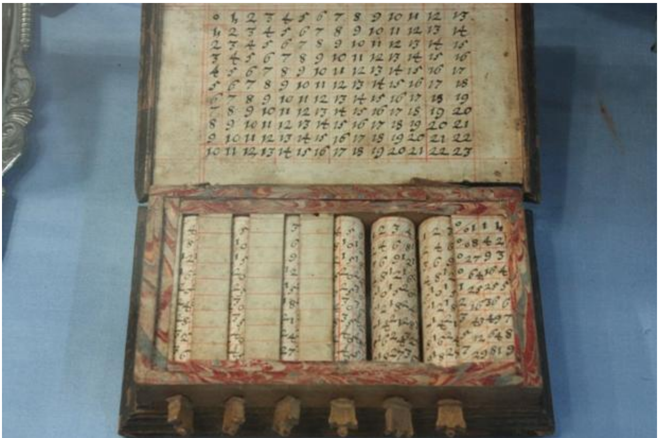
6. ábra: A Napier-számológép belülről
